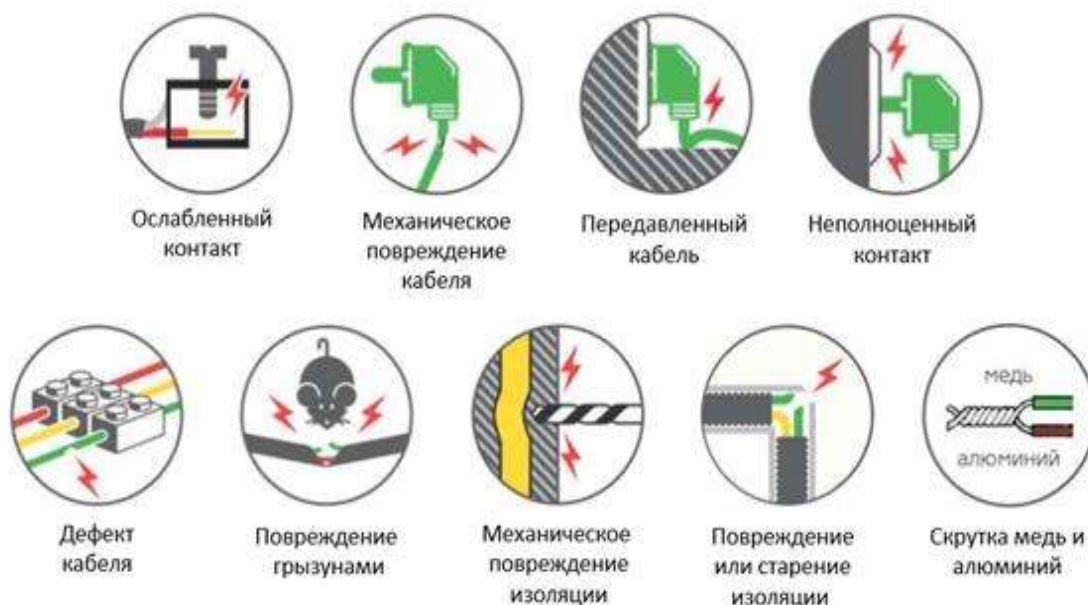
Рисунок 6. Возможные причины искрения в электропроводке
